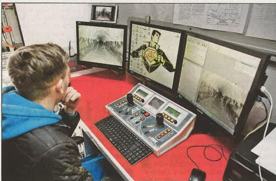
Der Kontrollraum: Ein Techniker hat auf mehreren Monitoren das Geschehen unter der Erde im Blick und kann von dort die Sonde und die Kamera steuern.
