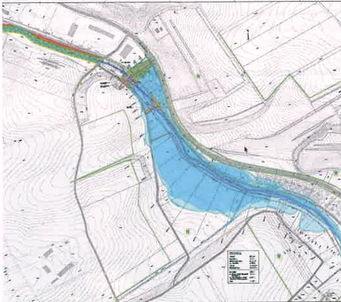
Plan zum Bau des Rückhaltebeckens in Altwiesloch mit in blauer Farbe dargestelltem Einstaubereich. Grafik: Stadt Wiesloch
